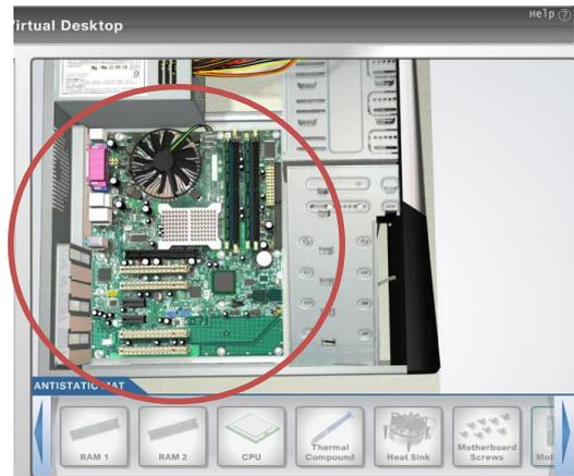
**Gambar 2.17** Pemasangan Motherboard pada casing
