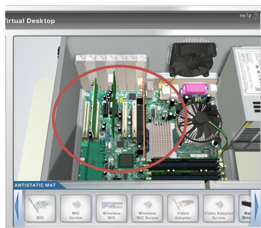
**Gambar 2.20** Pemasangan Card Adapter
